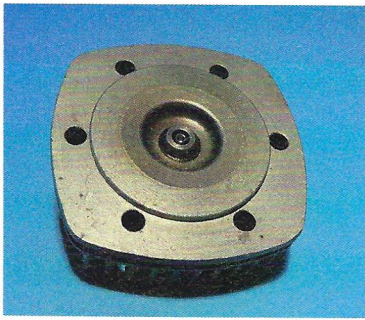
Der Brennraum des Magnum .40 mit G5-Kerze.
